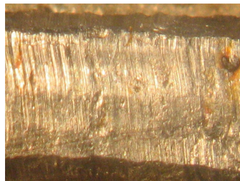
Fig.4-Topo do filete que falhou
