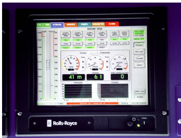
Foto 6: Instrumento para controle e monitoramento da operação das linhas de ancoragem.
