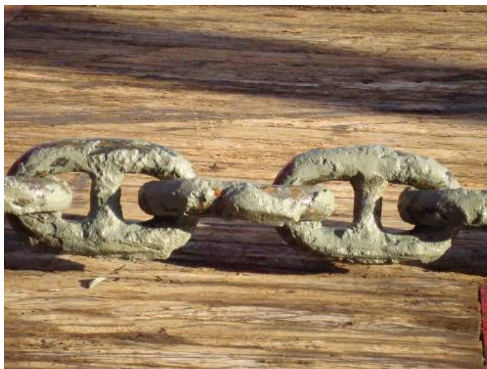
Foto 4: Amarra encostada no fundo do mar coberta de lama.
