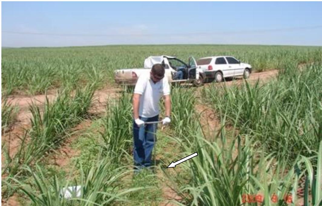
**Foto 1.** Início da coleta de amostra de solo a trado manual.
