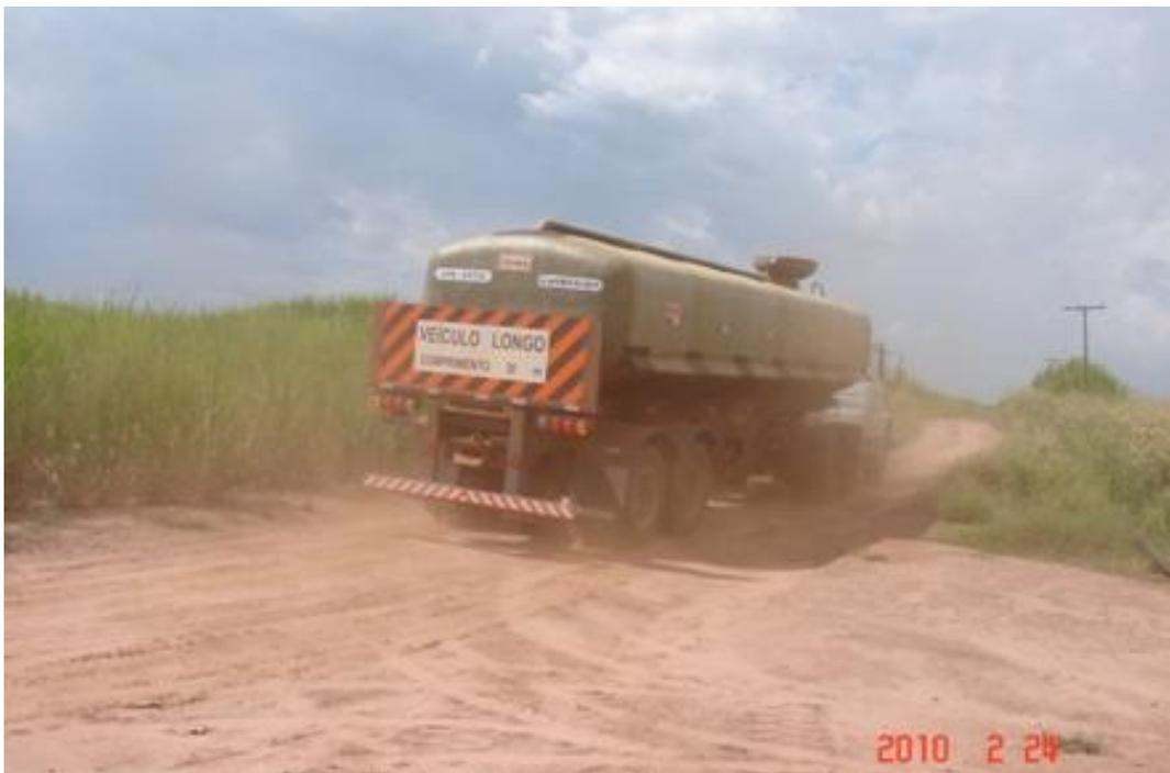
**Foto 16.** Distribuição de vinhaça por caminhões-tanque para os pontos de aplicação.
