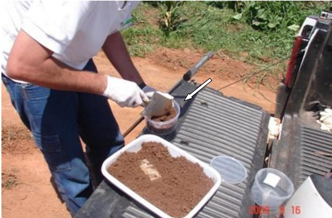
**Foto 3.** Colocação da amostra de solo em embalagem plástica a ser refrigerada.
