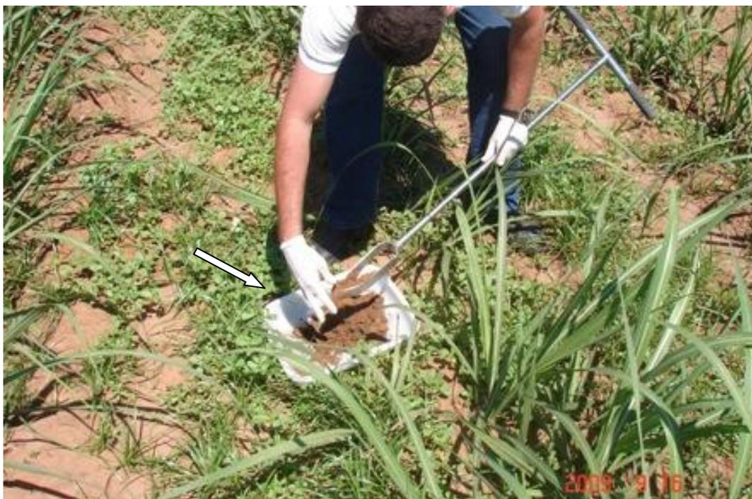
**Foto 2.** Retirada da amostra de solo do trado manual.
