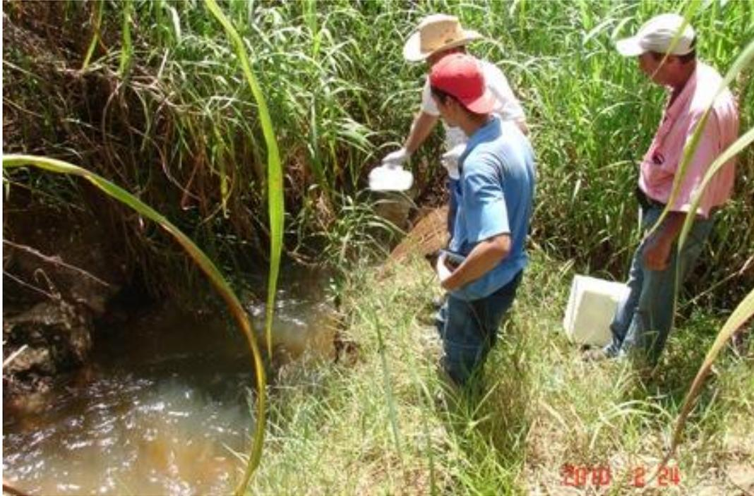
**Foto 7.** Início da coleta de amostra de água superficial no vertedouro da represa.
