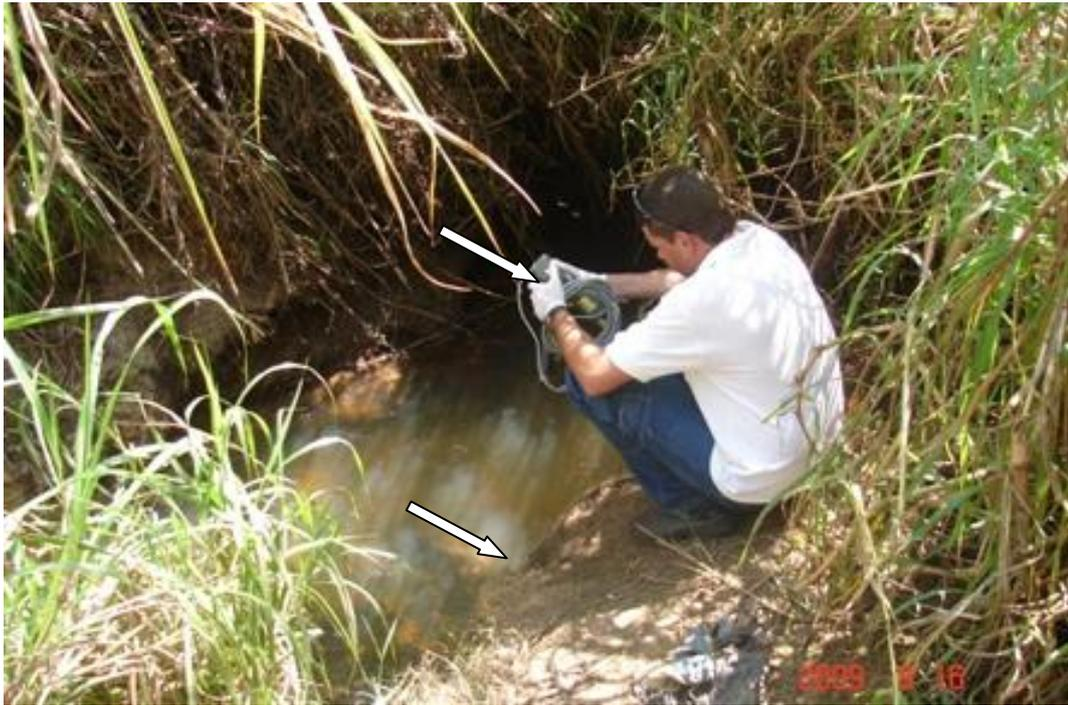
**Foto 5.** Medição instantânea de temperatura, PH e OD no local da coleta de amostra de água superficial no vertedouro da represa.
