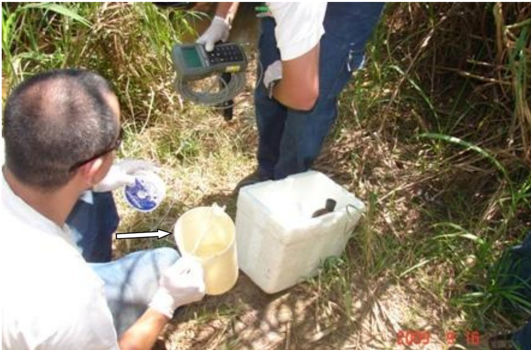
**Foto 8.** Coleta de amostra de água superficial no vertedouro da represa.
