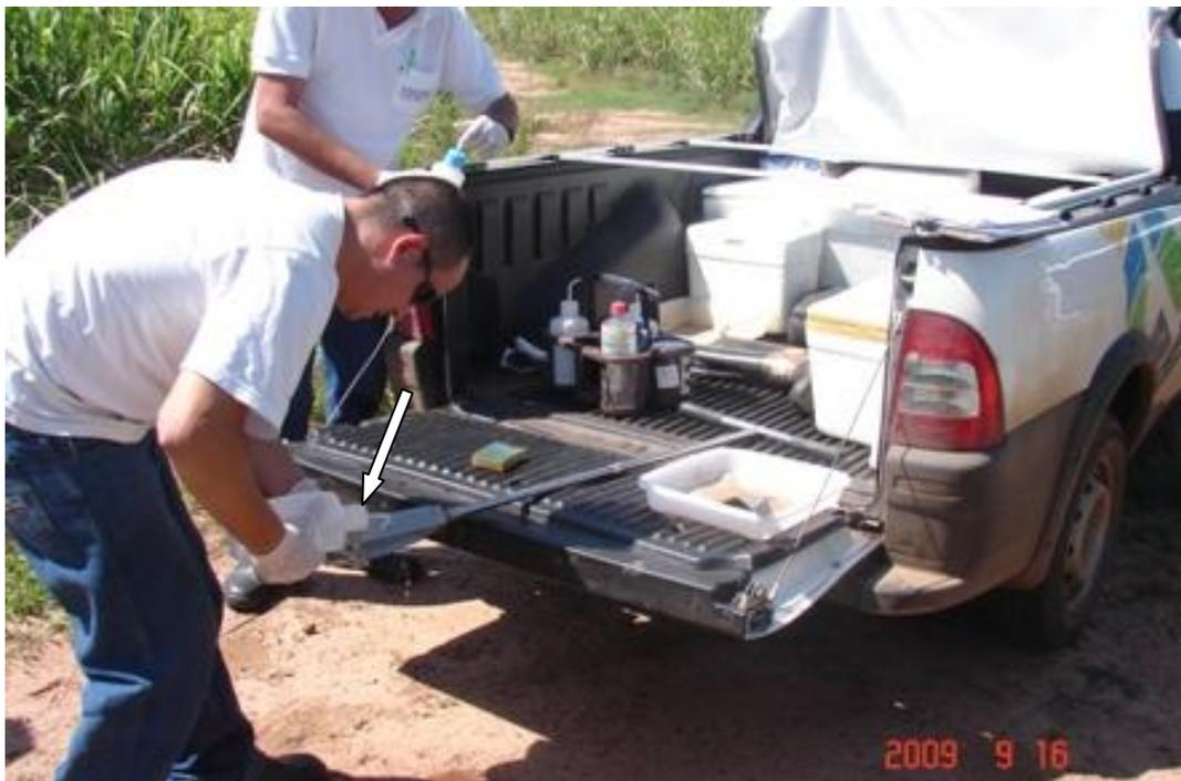
**Foto 4.** Lavagem do trado manual para utilização na próxima coleta.
