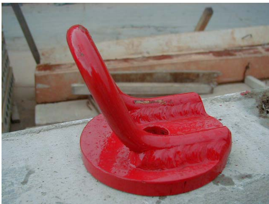
Figura 08 – Vista da peça similar àquela rompida na ocasião do sinistro.
