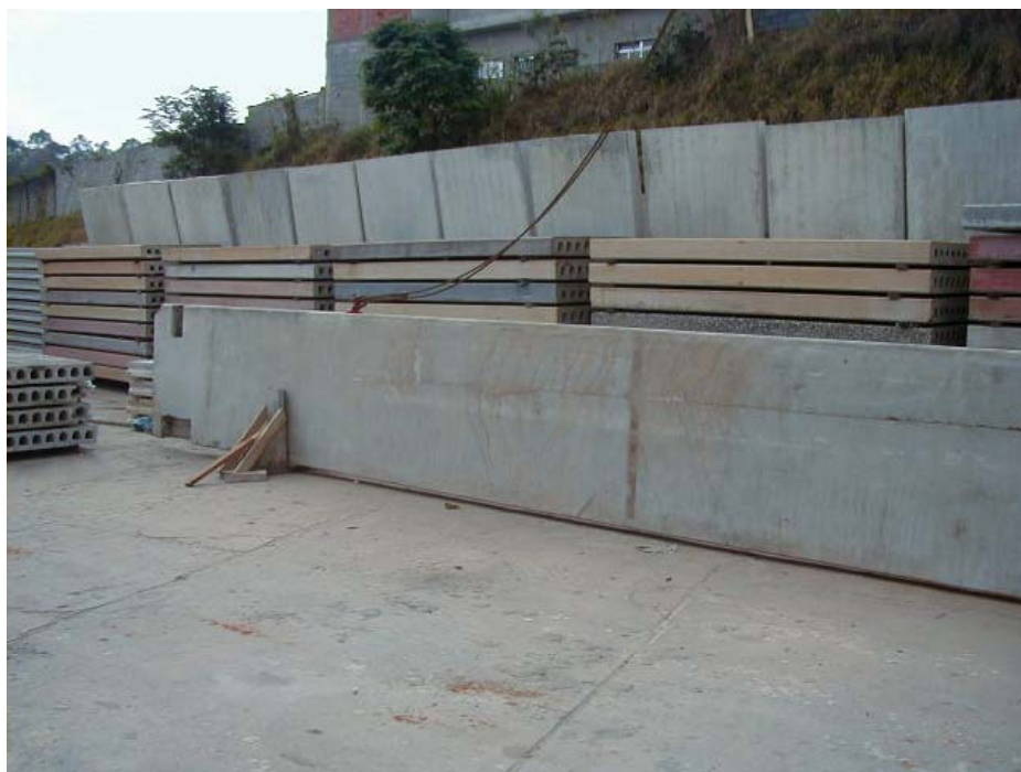
Figura 01 – Peça de concreto constituinte da futura laje, similar àquela que estava sendo içada na ocasião do acidente.
