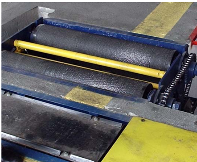
FIGURA DISPOSITIVO PARA VERIFICAÇÃO DE FRENAGEM
