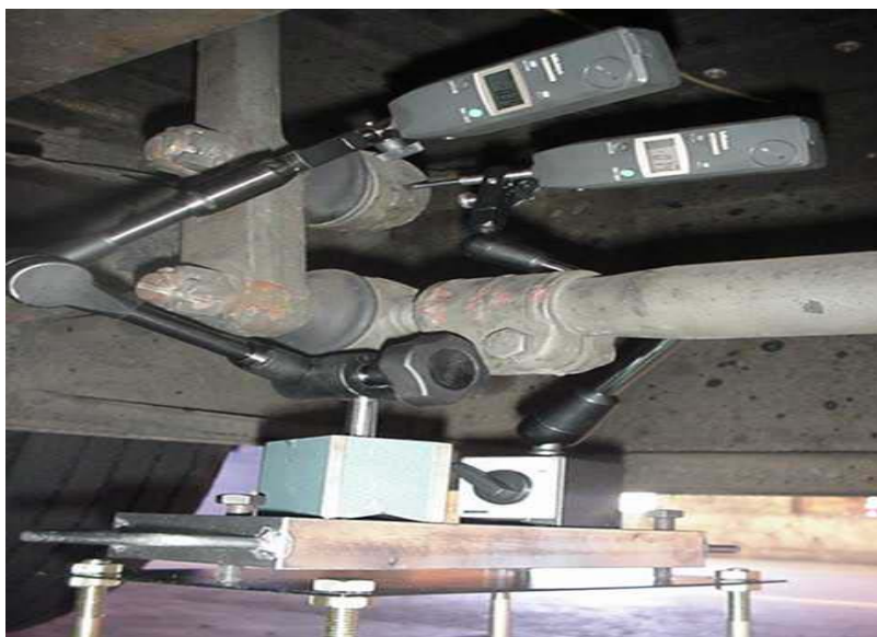
FIGURA DISPOSITIVO PARA VERIFICAÇÃO DE FOLGAS EM BARRAS DE DIREÇÃO
