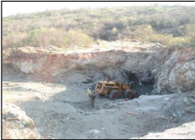
FOTO Nº. 08 – VISTA DE CARREGADEIRA DA MARCA MICHIGAN RETIRANDO R.O.M. NA MESMA JAZIDA MOSTRADA NA FOTO DE Nº. 08 SUPRA.
