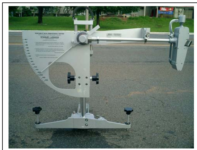
Figura 4: Equipamento "Pêndulo Britânico", utilizado para medição da microtextura.
