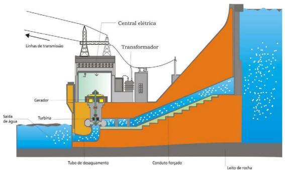
Assim a energia gerada é levada através de cabos ou barras condutoras dos terminais do gerador até o transformador elevador onde tem sua tensão elevada, através de linhas de transmissão até os centros de consumo.
