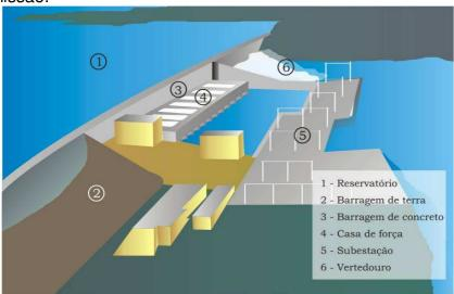
Quanto ao funcionamento propriamente dito de uma usina hidrelétrica, esta inicia-se com a captação de água no lago formado pela barragem, que é conduzida até a casa de força através de canais, túneis ou condutos metálicos. Após passar pela turbina hidráulica, na casa de força, a água é restituída ao leito natural do rio, através do canal de fuga.
