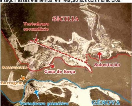
Após o levantamento planialtimétrico realizado, resumimos os componentes da usina, devidamente individualizados entre os dois municípios:
