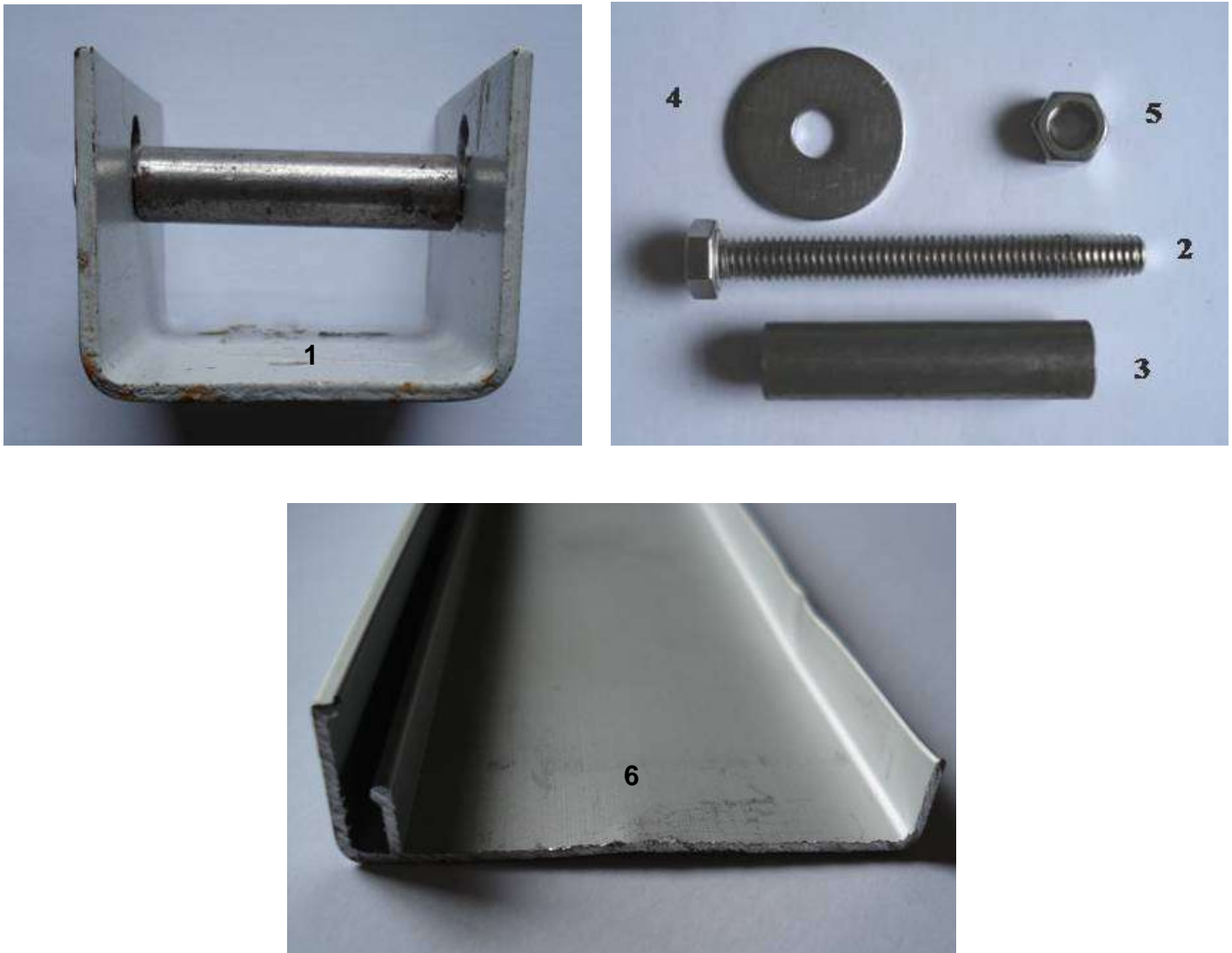
Figura 4 – Peças componentes do sistema metálico avaliado: (1) Perfil “U”; (2) Parafuso; (3) Cilindro; (4) Arruela; (5) Porca; (6) Trilho.
