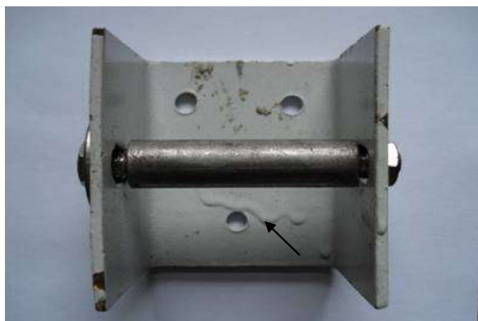
Figura 6 – Imagem mostrando aplicação irregular do recobrimento protetor.
