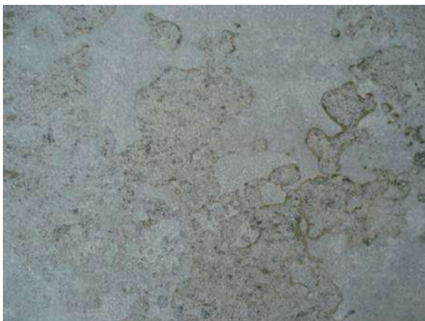
Figura 12 – Fotografia indicando que nem todo o verso da placa de rocha ficou em contato com a argamassa de assentamento.
