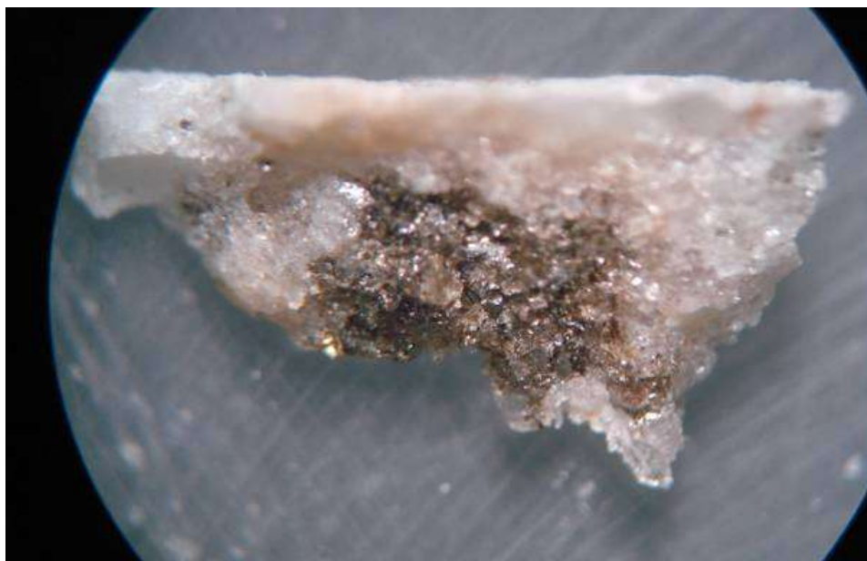
Figura 19 – Detalhe do manchamento amarelado no entorno dos minerais com íons ferro.
