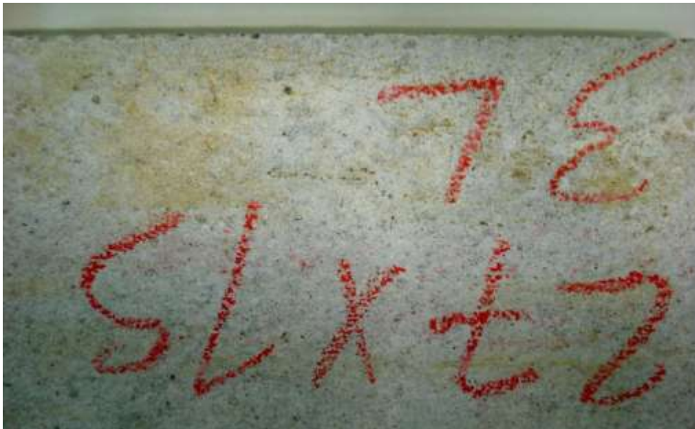
Figura 6 – Verso da placa de granito com depósitos castanhos.
