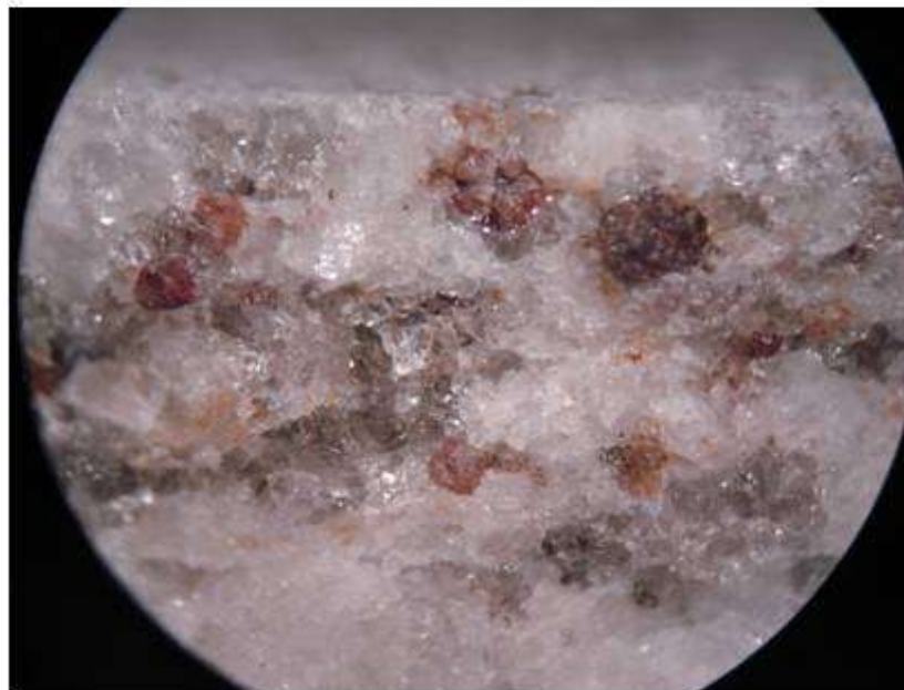
Figura 4 – Detalhes de região amarelada na superfície devido à presença dos minerais escuros na seção transversal da rocha sob a superfície. (a) Superfície polida e (b) seção transversal (20X).
