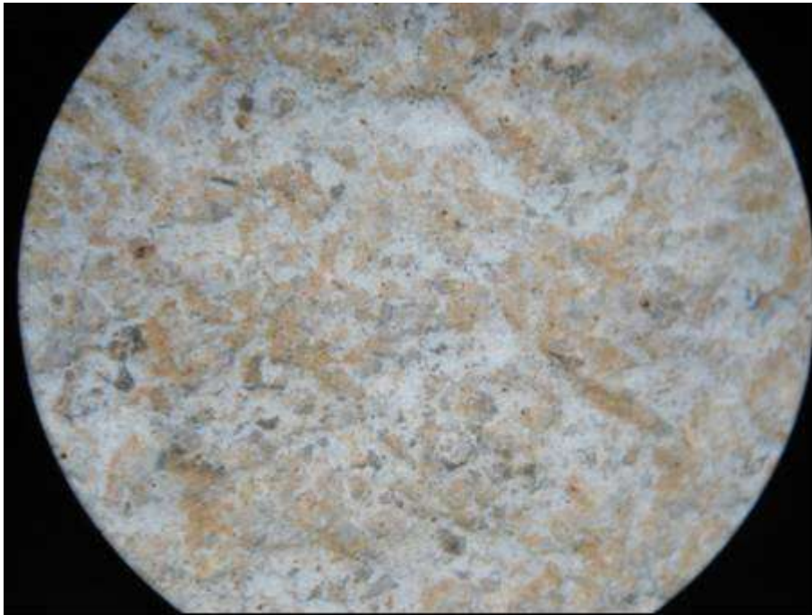
Figura 7 – Imagem ampliada (20X) dos depósitos castanhos característicos de resíduo de granalha oxidada.
