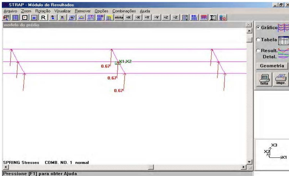
Figura 54 – Máxima tensão obtida, a qual remonta em 0,67kgf/cm<sup>2</sup>.
