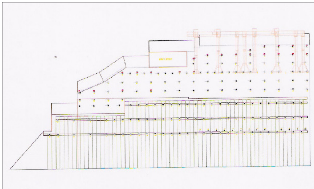
Locação esquemática das cabeças dos tirantes ao longo da cortina Atirantada.
