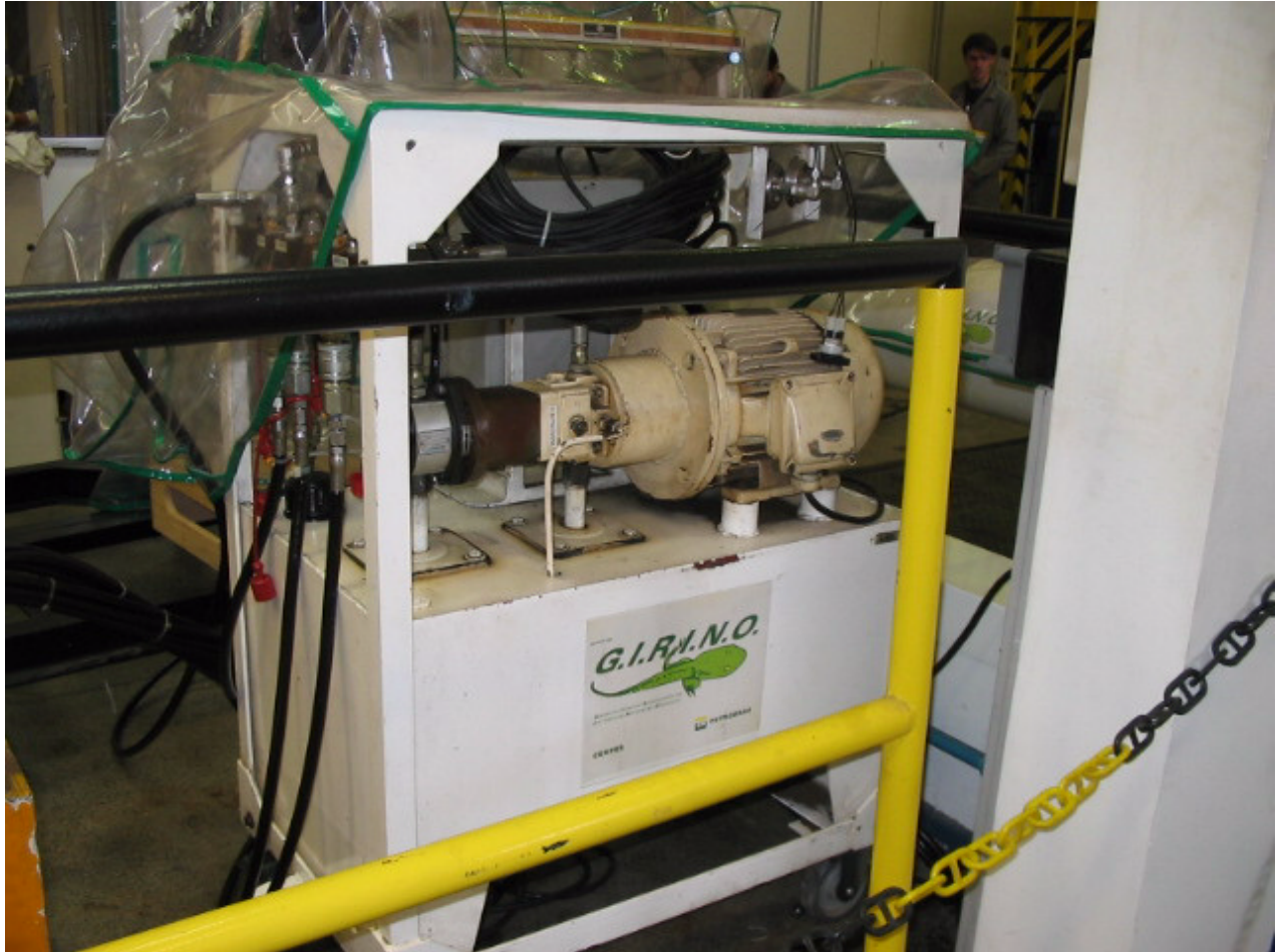
FOTO 03: MÓDULO HIDRÁULICO EXTERNO. O OBJETIVO DA IDA PARA A INGLATERRA É MINIATURIZAR ESTE MÓDULO PARA SER INCORPORADO AO PROTÓTIPO DE 16'.
