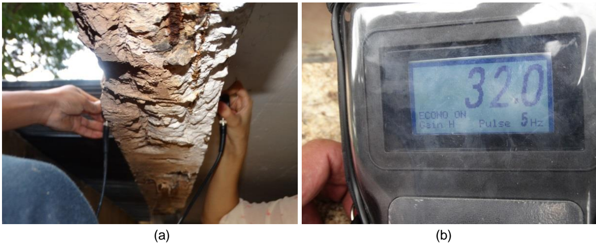
Figura 29: Ensaio de ultrassonografia. (a) viga de bordo da vaga 604; (b) Leitura efetuada no circuito medidor do tempo de propagação da onda
