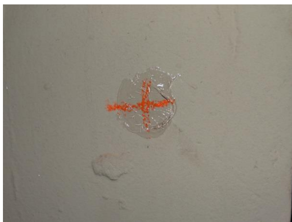
Figura 27: Vaselina aplicada sobre a superfície de ensaio
