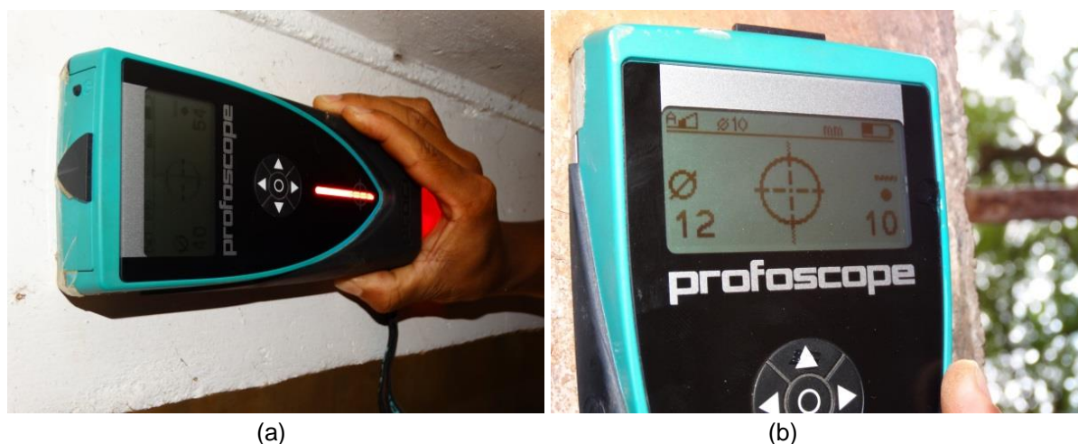
Figura 21 (a) e (b): Ensaio de pacometria realizado na viga do poço de inspeção da vaga 407
