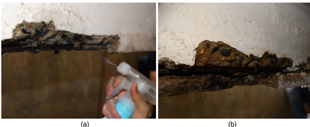
Figura 26: Ensaio de determinação da penetração de frente de carbonatação na viga de bordo da vaga 604; (a) Aspersão de fenolftaleína na superfície de ensaio; (b) Área ensaiada sem alteração na coloração.
