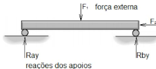
Nesta ilustração vemos dois apoios, a e b, duas forças externas atuantes:  $F_1$  - força externa somada ao peso próprio da barra, provocando as reações de
