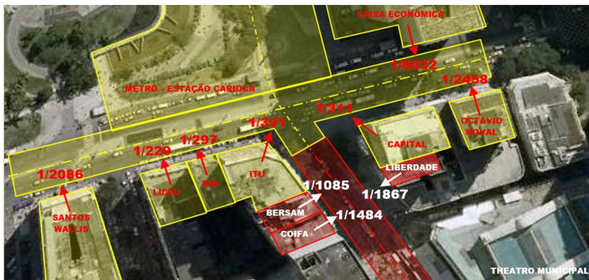
RECALQUES DIFERENCIAIS ESPECÍFICOS APÓS A OBRA – FINAL DE 1978
