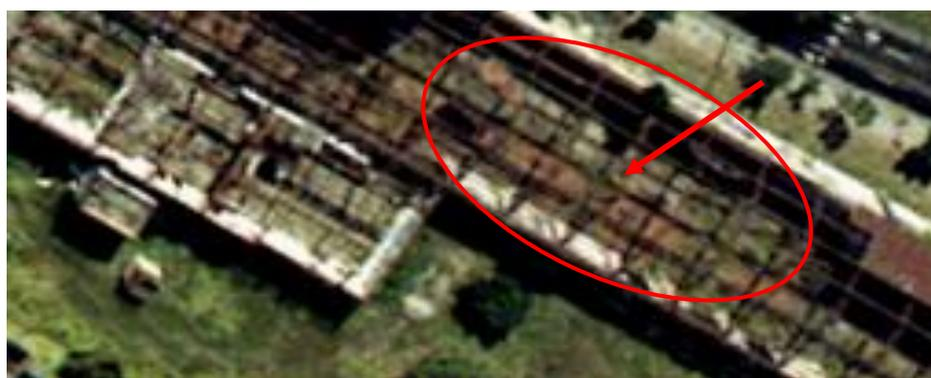
AUSÊNCIA DAS HISTÓRICAS TESOURAS TRANSVERSAIS DO GALPÃO PRINCIPAL E AS TELHAS DO TIPO MARSELHA ORIGINAIS DO TELhado DE ANTES 1907
