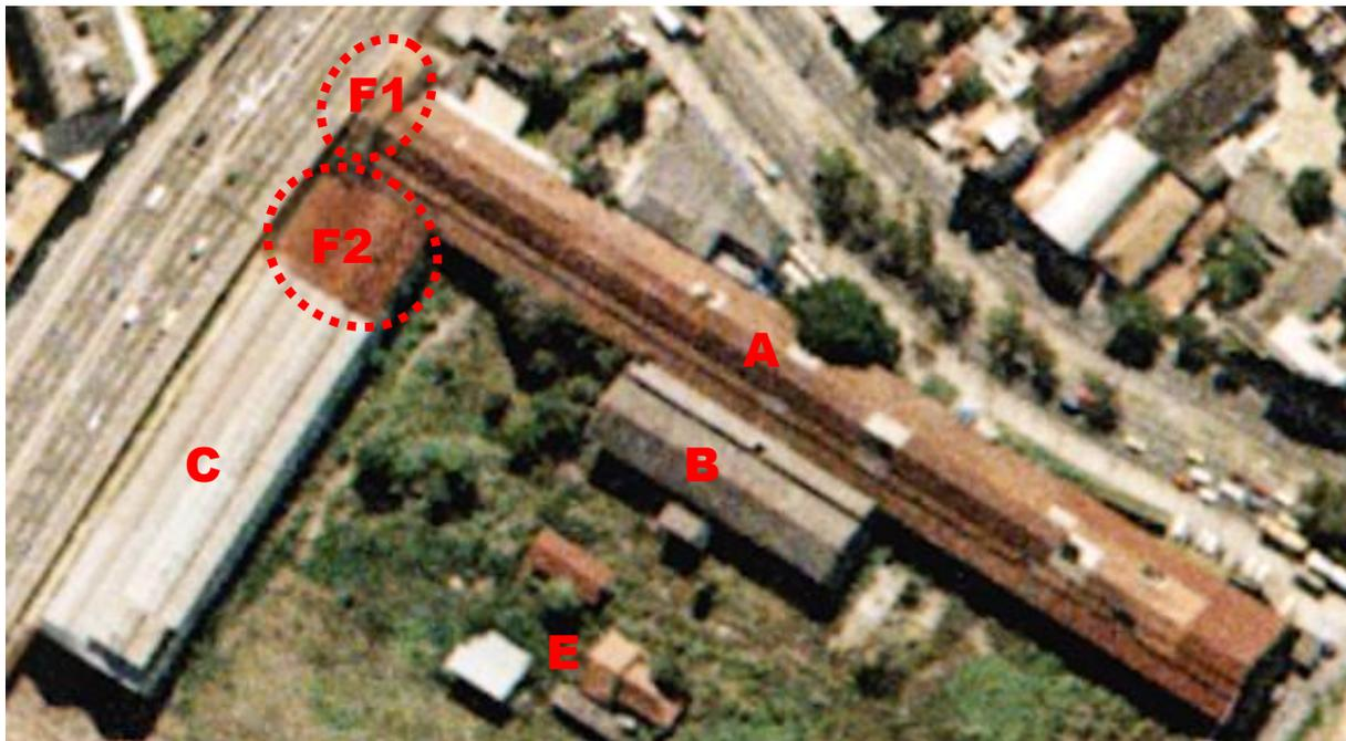
GALPÃO A NO ESTADO REMANESCENTE DA CONSTRUÇÃO ORIGINAL DA CIA. DE CURTUMES DE SÃO LÁZARO DE ANTES DE 1907 DOTADO DE TELHADO DE 8.000m<sup>2</sup> EXECUTADO COM TELHAS DO TIPO MARSELHA, DA MARCA DOS FABRICANTES FRANCESES GUICHARD CARVIN & C., ROUX FRÈRES E PIERRE SACOMAV
