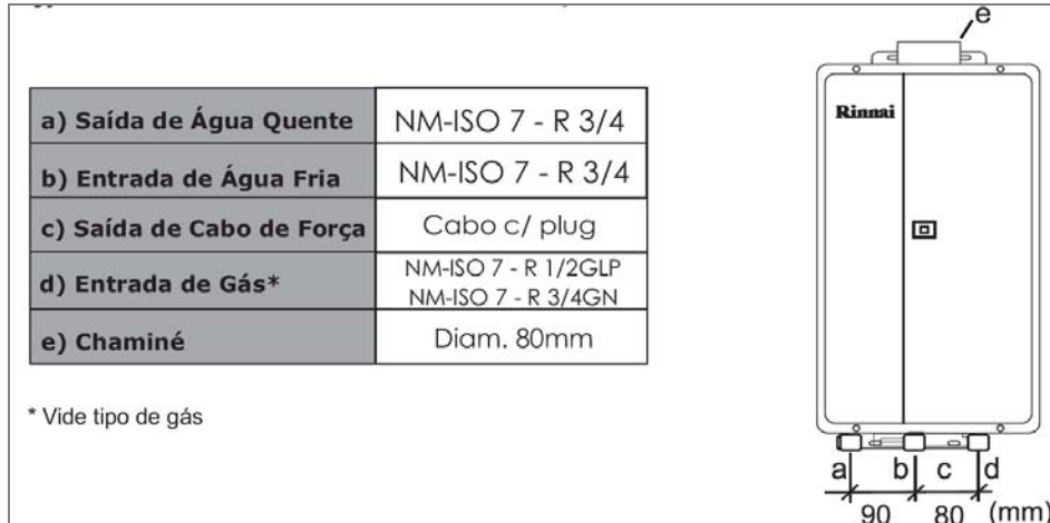
Ilustração 10 - Identificação dos pontos de água e gás no aquecedor Rinnai, modelo REU-2802 FEC (entrada de gás à direita). Fonte: Manual do Fabricante.
