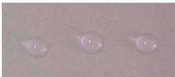
Figura 12 – Gotas de água depositadas na superfície do porcelanato após escovação.
