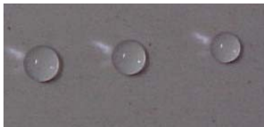
Figura 10 – Gotas de água depositadas na superfície do porcelanato sem limpeza.
