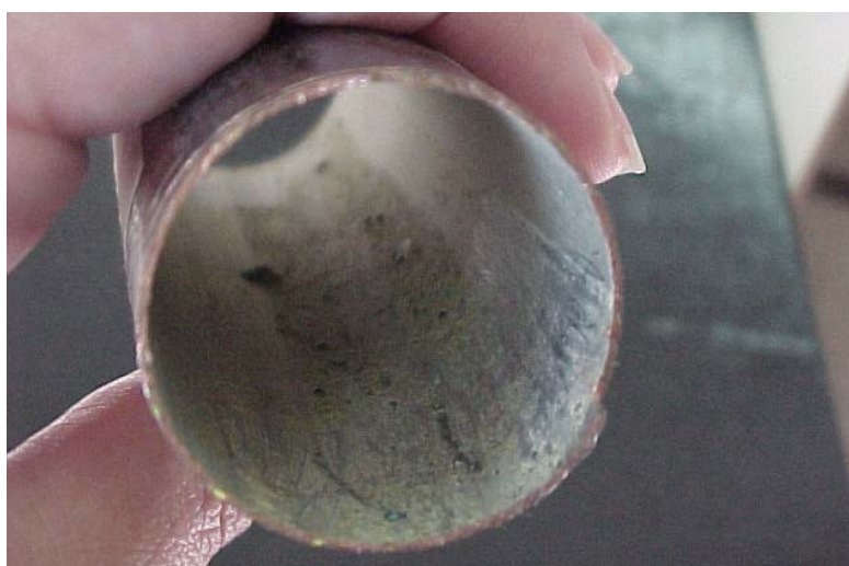
Figura 3 – Depósito de material no diâmetro interno da amostra A94.
