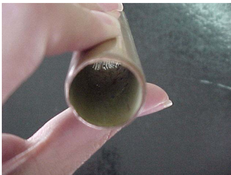
Figura 6 – Interior do tubo de cobre da amostra B86.
