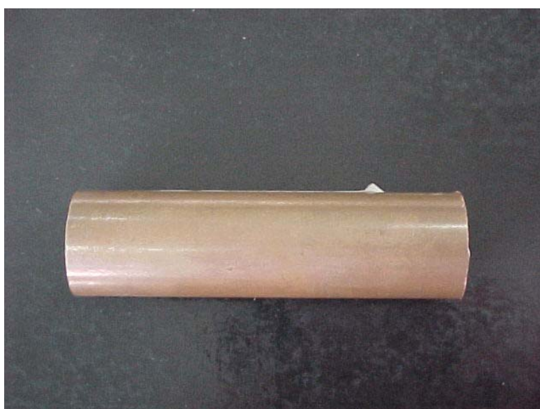
Figura 7 – Superfície externa do tubo de cobre sem uso (amostra C04).
