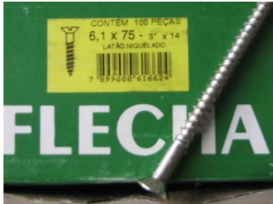
Foto n° 4: Vista do parafuso em latão niquelado utilizado em alguns pontos da fachada.
