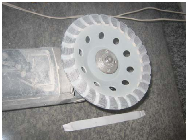
Foto nº 5: Vista da lixadeira para polir a superfície do concreto onde será aplicada a manta de fibra de carbono
