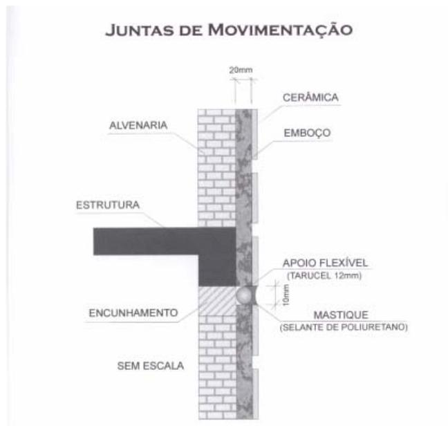
Figura 01 – Exemplo de junta de movimentação
