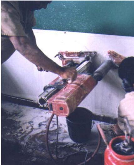
a) equipamento para extrair testemunhos cilíndricos de concreto.
