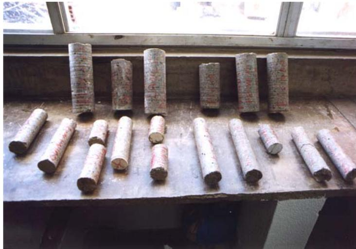
b) Corpos de provas, testemunhos, de diversos tamanhos e diâmetros retirados de uma estrutura de concreto.
