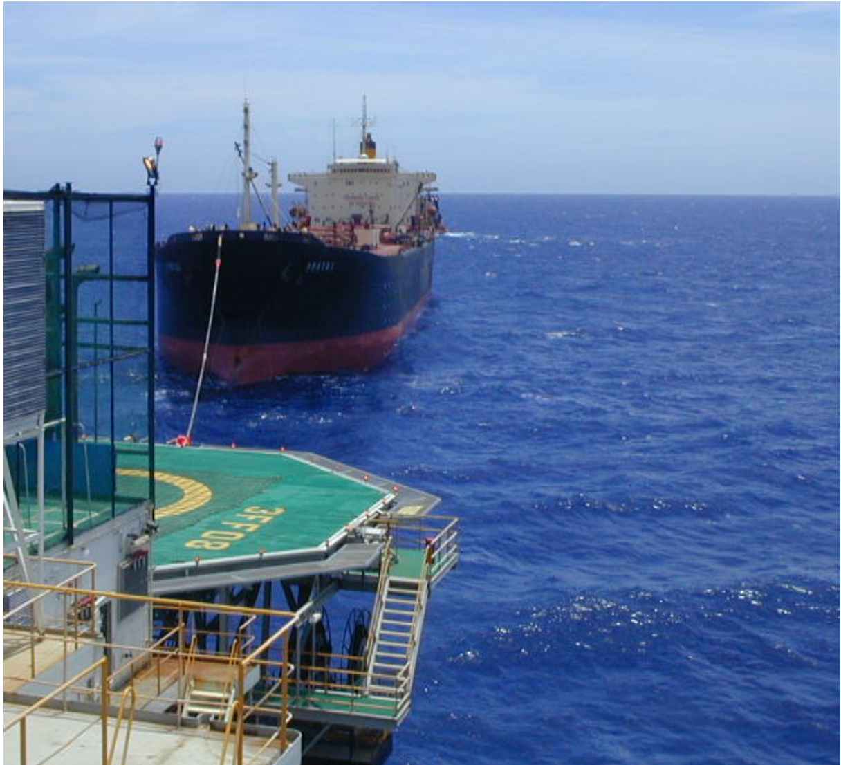
Navio tanque aliviador, recebendo petróleo de uma plataforma de produção.
