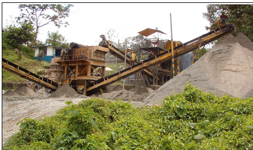
Foto 12. Planta de trituración instalada en la arenera.
