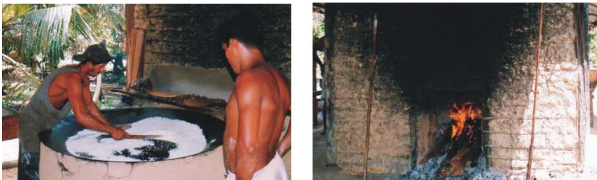
Fig. 06 – Utilização de taipa na casa de farinha.
