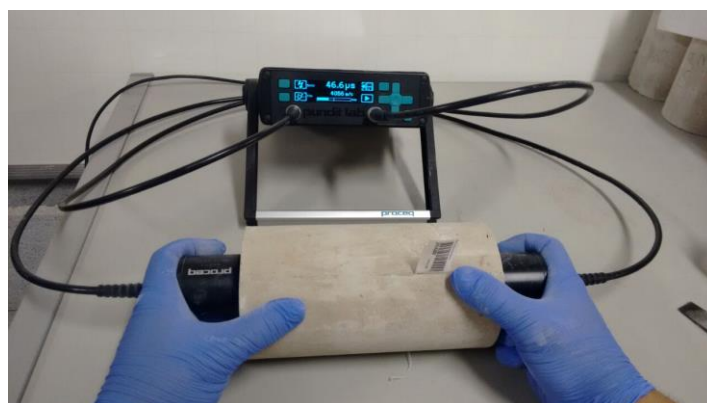
Figura 4: Ensaio de ultrassom no concreto no estado endurecido
