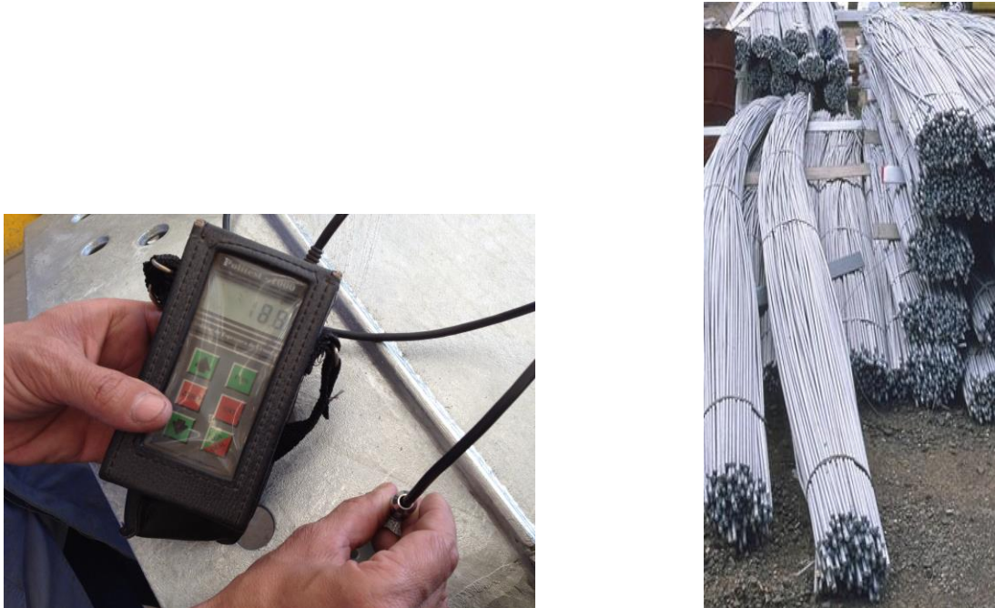
Figura 13 – Controle da espessura da camada de zinco e aparência do produto final
