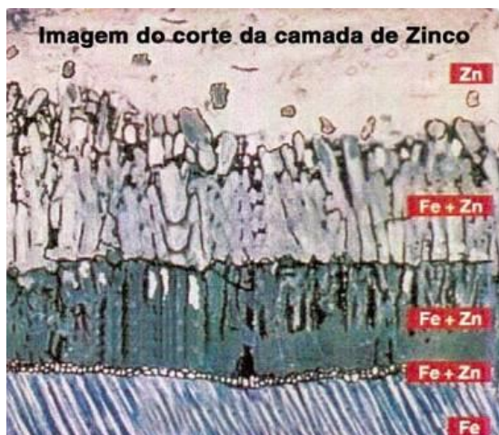
Figura 4 Esquema típico de um revestimento galvanizado por imersão a quente Fonte: YEOMANS, 2004
