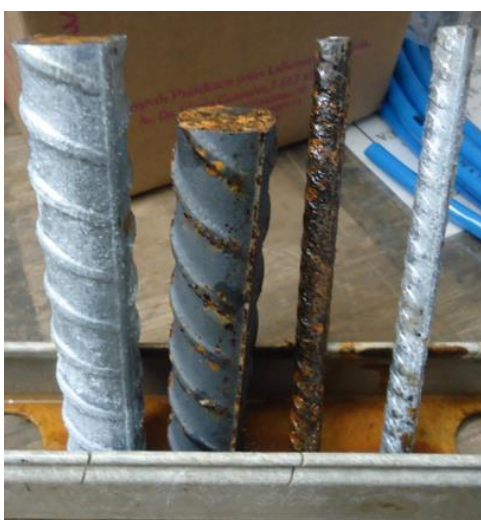
Figura 16 Aspecto das barras após ensaios acelerados em câmara úmida
