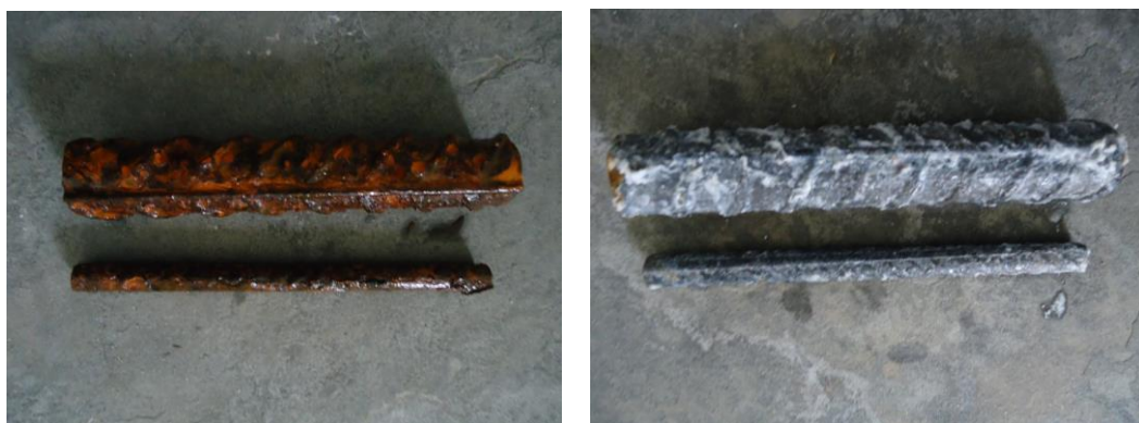
Figura 15 Aspecto das barras com e sem galvanização após 28 dias de imersão em câmara salina
