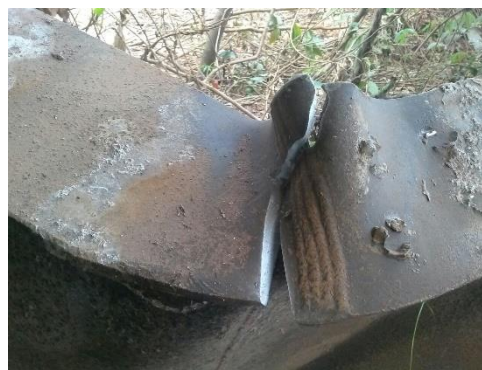
Figura 10: Ruptura da mesa da longarina.
