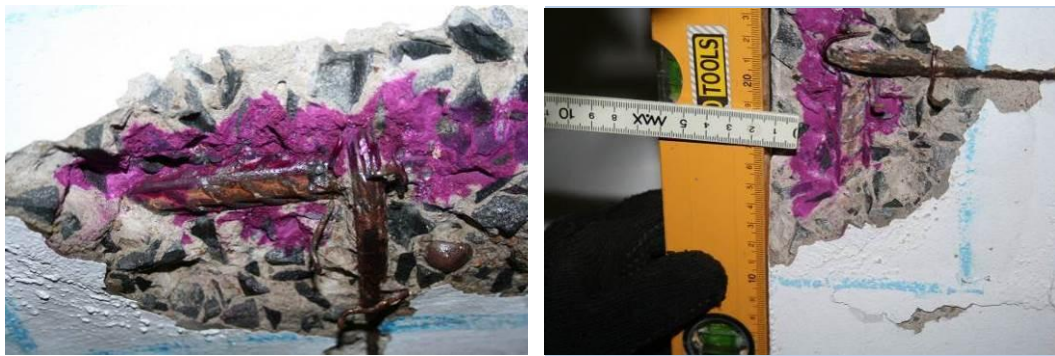
Superfície marcada pelo reagente em uma profundidade média de 20mm de carbonatação em ambas as faces de viga ensaiada
