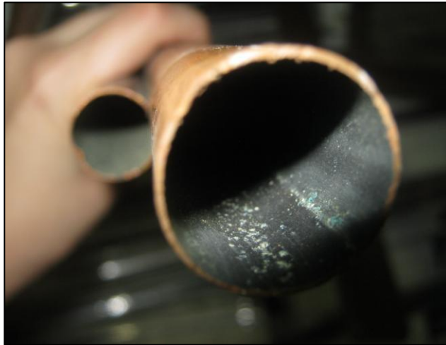
Tubo “CLASSE E NBR 13206 – SEM COSTURA”, tubo com sujidades.
