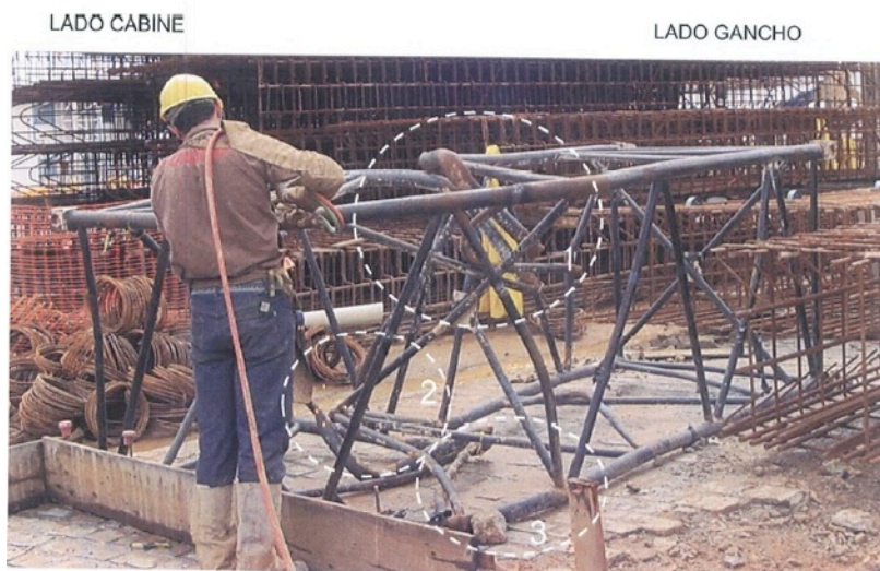
Img. 30 – Operação do corte efetuado no canteiro para retirada das amostras (Fonte: laudo IPT)
