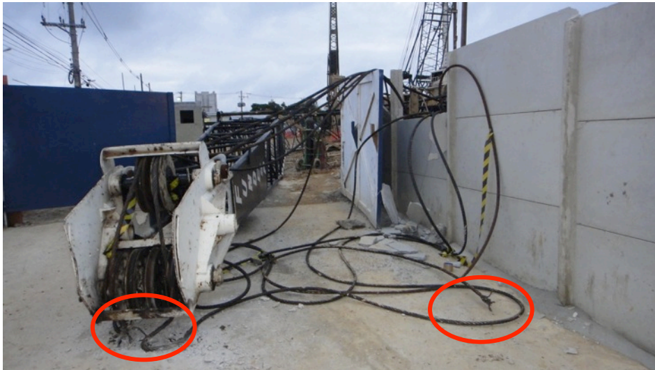
Img. 22 – Rompimento do cabo de aço por cisalhamento causado por esmagamento
