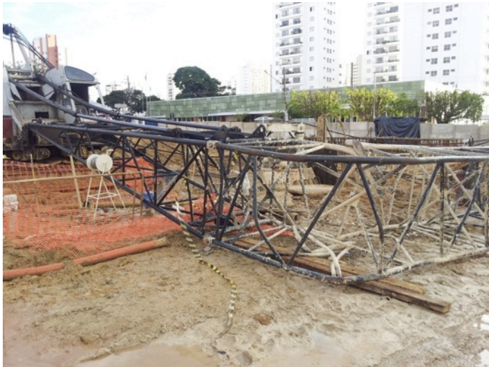
Img. 28 – Vista da lança na sua região de ruptura, após o acidente
