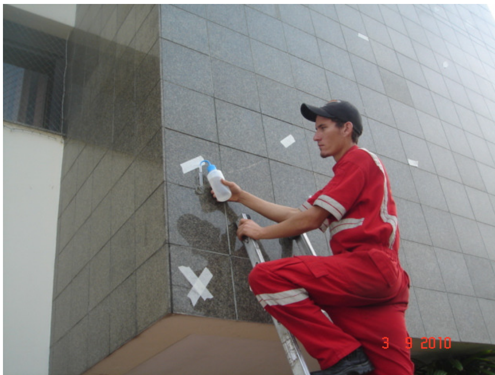
Figura 32: TESTE DE PERMEABILIDADE A BAIXA PRESSÃO sendo realizado com uso de TUBO KARSTEN.
