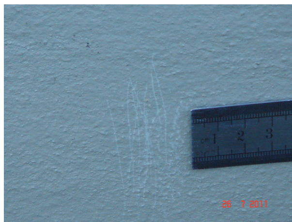
Figura 17 – Confecção/ Expedição. Face Oeste. No detalhe, inexistência de manchamento mesmo após realização de procedimento de abrasão.
