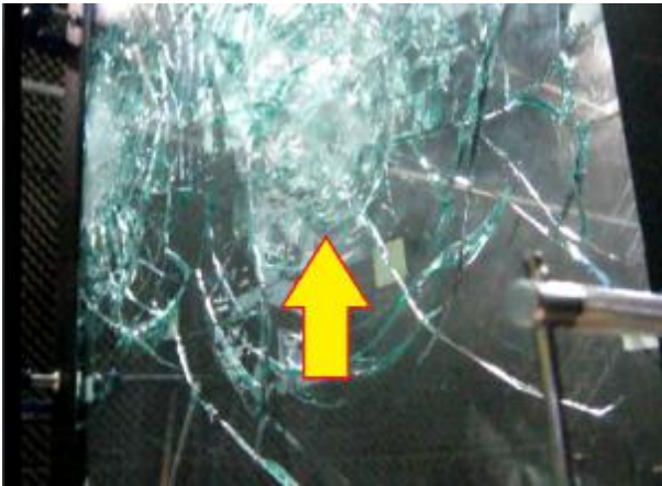
Terceiro impacto na região central do vidro. Vista por trás do vidro
