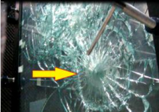
Vista por trás do vidro Quarto impacto na região inferior do vidro
