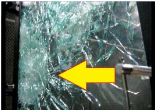
Quarto impacto na região inferior do vidro. Vista por trás do vidro.
