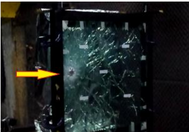
Primeiro disparo na parte superior do vidro. Vista frontal
