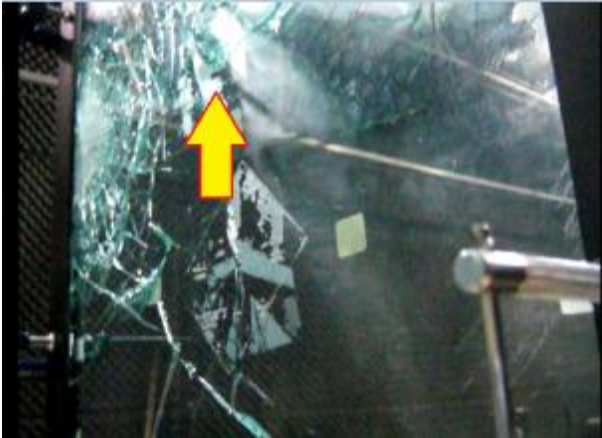
Segundo disparo também na parte superior do vidro. Vista por trás do vidro
