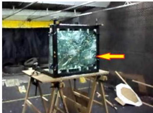
Quarto impacto na região inferior do vidro. Vista frontal do vidro.
