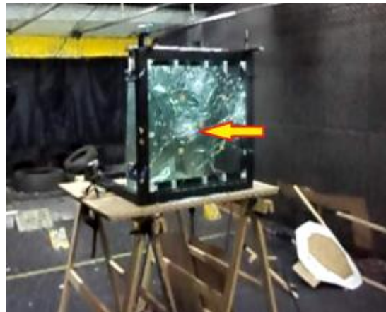
Terceiro impacto na região central do vidro. Vista frontal do vidro
