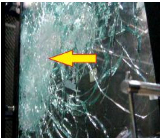
Vista frontal. e por trás do vidro. Houve rompimento do papel testemunho por lançamento de estilhaços de vidro, porém sem transfixação do mesmo.
